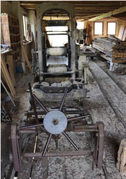
Funktionsfähiges altes Gatter in der Theuerleinsmühle bei Röhrensee
